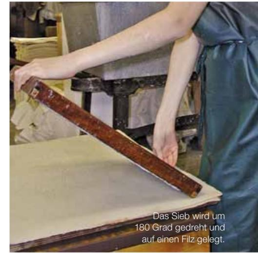
Das Sieb wird um 180 Grad gedreht und auf einen Filz gelegt.
