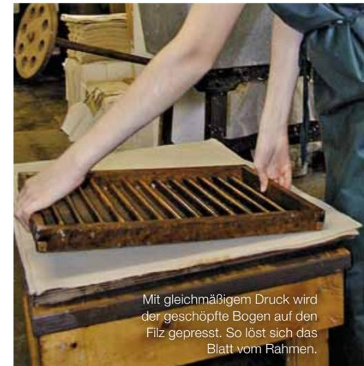
Mit gleichmäßigem Druck wird der geschöpfte Bogen auf den Filz gepresst. So löst sich das Blatt vom Rahmen.
