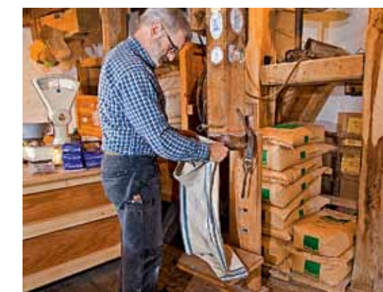
Franz-Josef Albers (Vereinsvorstand) befestigt einen Mehlsack an der „Mehlpeife“. Das ist eine Holzrutsche zum Absacken von Mehl.
