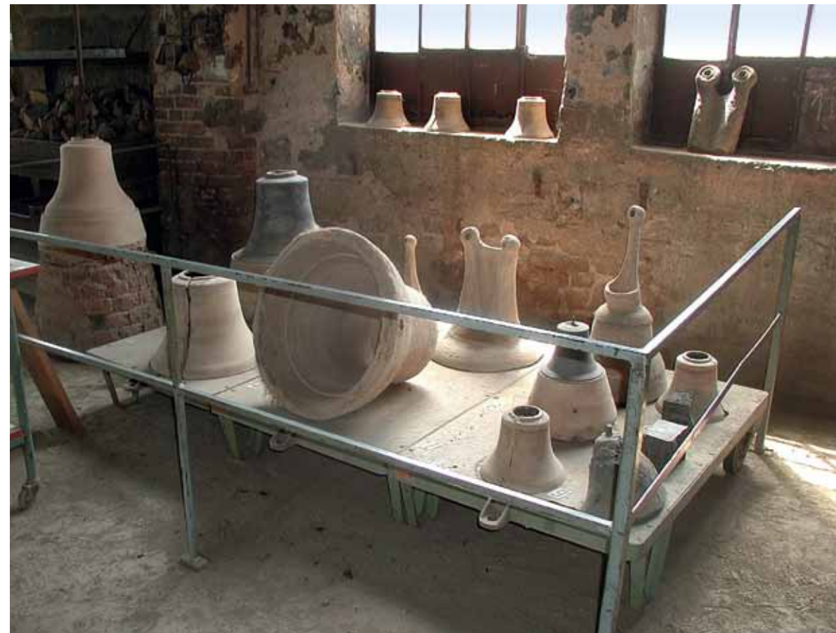
Die Ausstellungsmodelle veranschaulichen die Teile, die zur Herstellung einer Glocke notwendig sind: Kern, falsche Glocke und Mantel.
