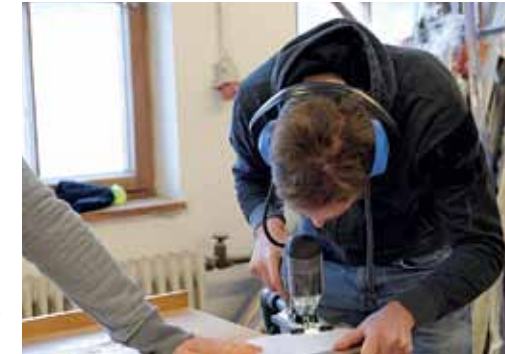
Bild links: Hier kommt es auf Genauigkeit an: Mit der Stichsäge wird der Ski nun vorsichtig ausgesägt. Bild rechts: Wenn der Ski fertig ist, kommt der letzte Schliff des Rohlings.
