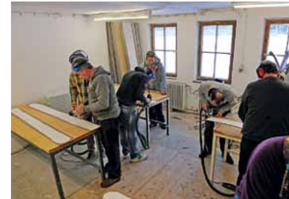
Bild links: Ein Ski besteht aus mehreren Schichten, nun wird das Oberste, das sogenannte Top-sheet, auf die richtige Länge gebracht. Bild rechts: Sobald alle Lagen verbunden sind, werden die Skirohlinge zugeschnitten und in die endgültige Skiform gebracht.
