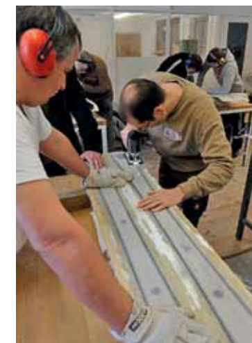
An Tag zwei werden die Ski mit einer Stichsäge ausgeschnitten.
