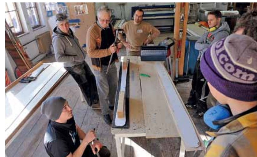
Den Skibelag gibt es in Transparent oder in Schwarz. Dieser muss auch in die Skiform gebracht werden. Dafür wird der Ski aufgelegt.
