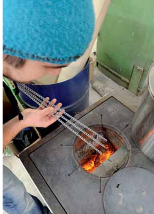
Um die Stahlkanten in die richtige Form biegen zu können, wird das Rohmaterial im Ofen erhitzt.
