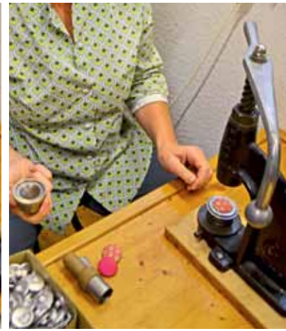
Den Deckel abheben und schon sind Blechrohling und Stoff verbunden.
