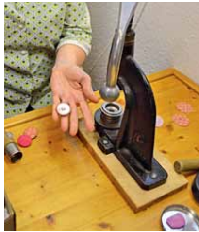
... und mit einer beherrzten Drehung am Hebel der Knopfmaschine wird beides fest zusammengepresst.
