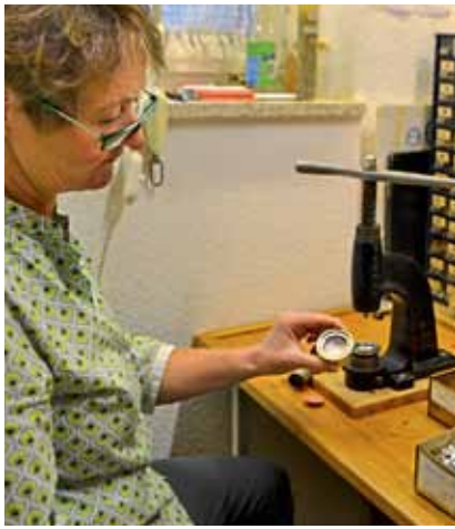
Im passenden Werkzeugoberteil wurden ausgestanzter Stoff und Rohling sorgsam eingelegt ...
