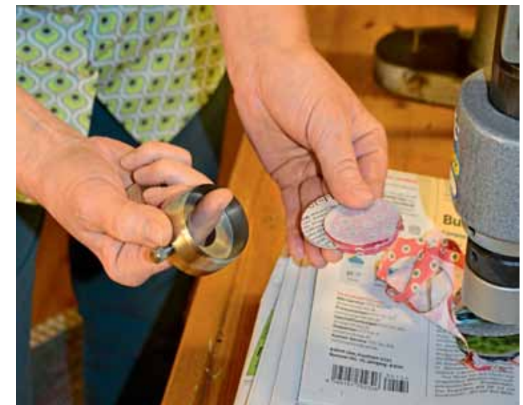
Bild oben: Nachdem Frau Ufer den passenden Stoff ausgesucht und evtl. noch mit Vlieseline unterbügelt und stabilisiert hat, stanzt sie mit der Maschine den Stoff in der richtigen Größe aus. Bild unten: Der Stoff hat nun den passenden Durchmesser für den Knopf und kann weiterverarbeitet werden.
