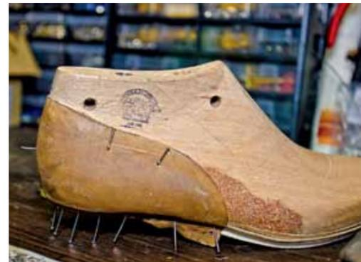
Bei größeren Hinterkappen kann diese extra auf dem Leisten befestigt werden. Der Schuhmacher nennt das „vorgezwickt“.
