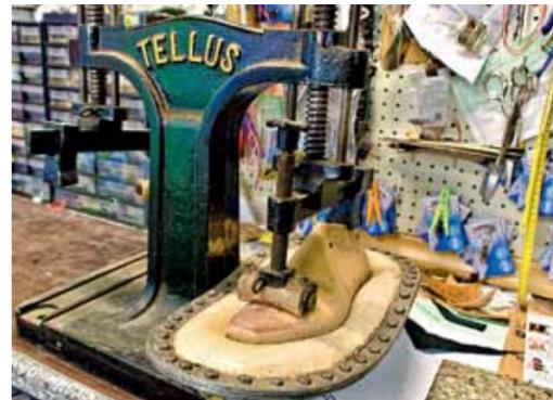
Mit der Spindelpresse wird Druck auf den Leisten ausgeübt, sodass die Brandsohle die Form annimmt.
