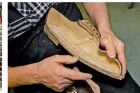
An dem aufgeschnittenen Modell ist gut zu erkennen, dass ein Schuh aus verschiedenen Schichten besteht.
