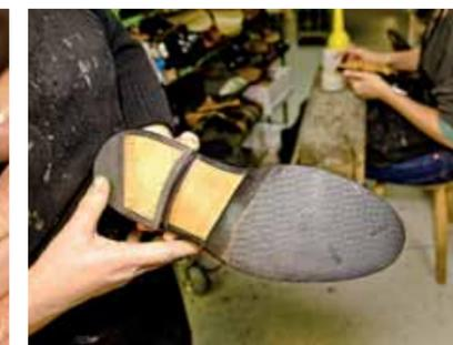
Jede Sohle ist ein Einzelstück und wird auf Maß zugeschnitten. Hier in Kombination: Leder- und Gummisohle.
