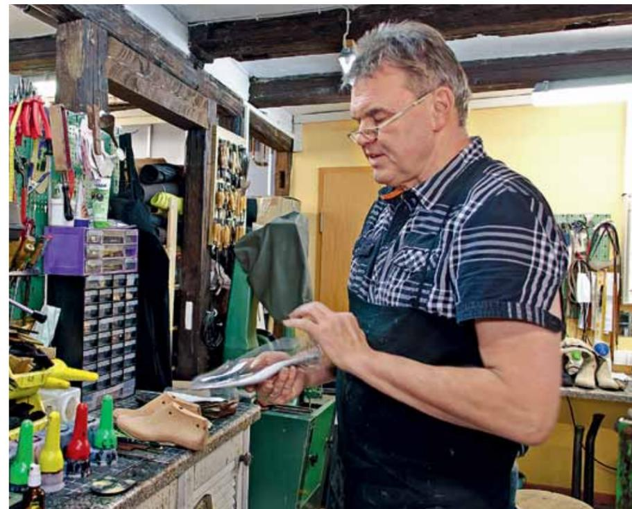
Ulrich Janke hält einen Probeschuh in seinen Händen, den er nach dem Leisten angefertigt hat. Passt dieser dem Kunden, wird der Schuh gebaut.
