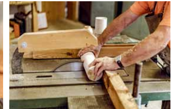
Die Radnaben werden auf der Drechselbank rund gedreht (Bild links) und anschließend mit der Kreissäge abgelängt (Bild rechts).
