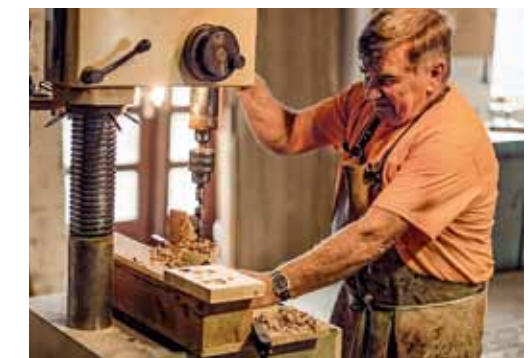
Mit einer großen Bohrmaschine wird ein Loch, Durchmesser 22 mm, mittig in die Nabe gebohrt, in das später die Laufbuchse mithilfe einer Handhebel- presse eingesetzt wird.
