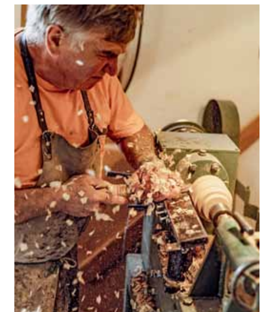
Dann muss die Nabe noch einmal auf die Drechselbank, um die Passungen für die vier Eisenringe herzustellen. Dabei muss sehr genau gearbeitet werden – denn ist der Außendurchmesser zu groß, passt der Ring nicht darauf, und ist er zu klein, gibt er der Nabe keine Stabilität.
