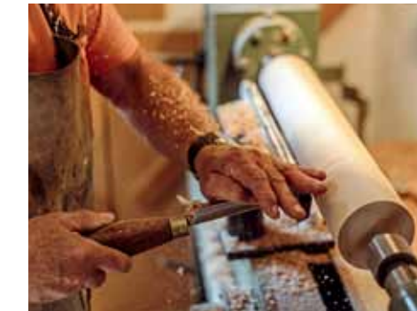
Die Radnaben werden auf der Drechselbank rund gedreht (Bild links) und anschließend mit der Kreissäge abgelängt (Bild rechts).
