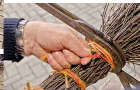
Damit der Besen hält, wird er an drei Stellen mit Sisalgarn oder Draht gebunden.
