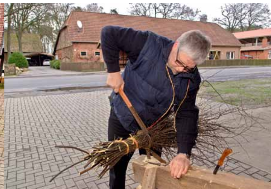
Damit der Besen hält, wird er an drei Stellen mit Sisalgarn oder Draht gebunden.
