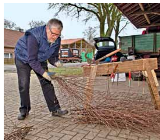
Zuerst bindet der Besenbinder die Birkenreiser. Er benötigt etwa drei Handvoll für einen Besen.
